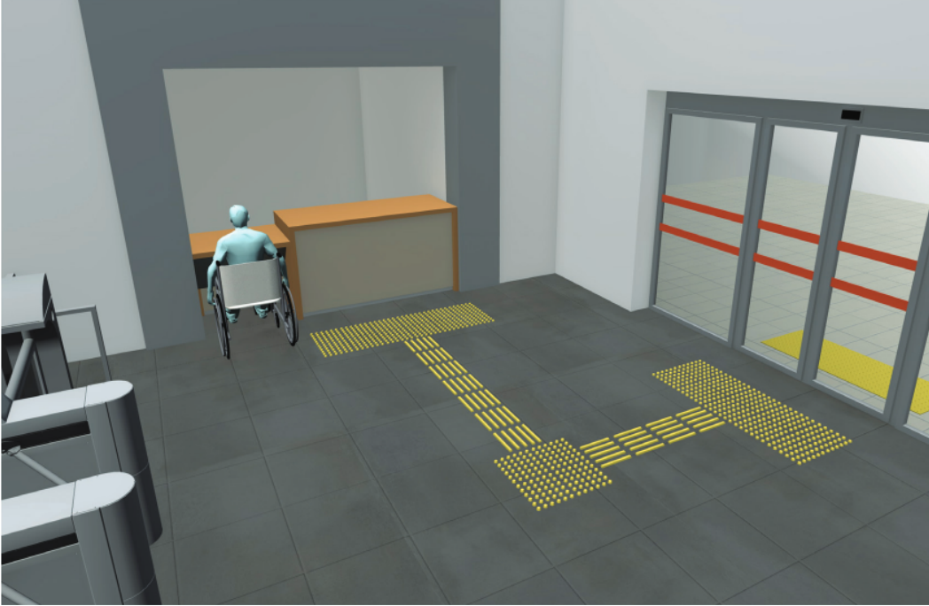
Şekil 11.7. Bina İçinde Kılavuz Yüzey Uygulaması
