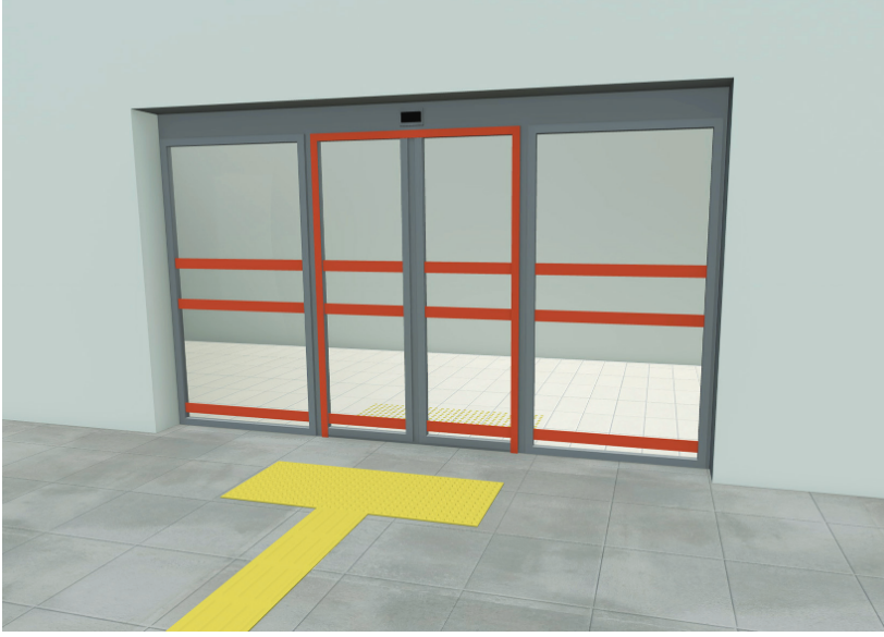
Şekil 4.5. Büyük Cam Yüzeyle Giriş Kapılarının İşaretlenmesi
